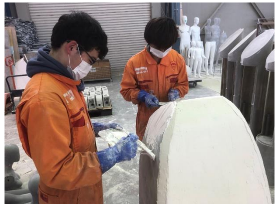
図7 パテによる補修
