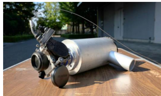
図9 製作途中のサージタンク及びスロットルボディの組み立て後の様子
