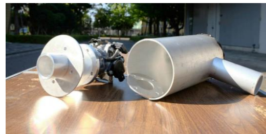
図8 製作途中のサージタンク及びスロットルボディの組み立て前の様子
