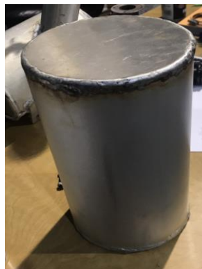
図 11 側面の溶接が完了した燃料タンク
