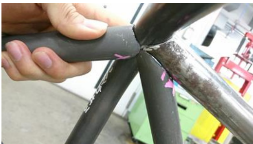
図2 フレームすり合わせの様子
