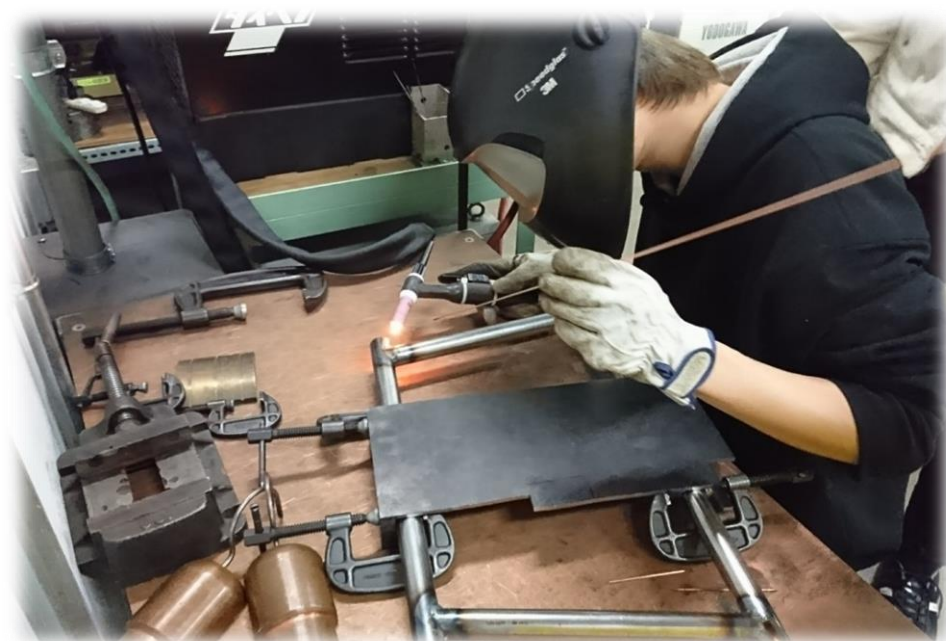
フレーム溶接の様子
