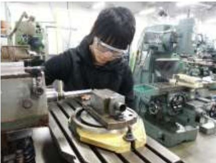
図8 パイプ端面のフライス加工の様子
