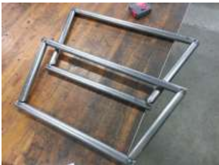
図9 溶接したフレームの一部
