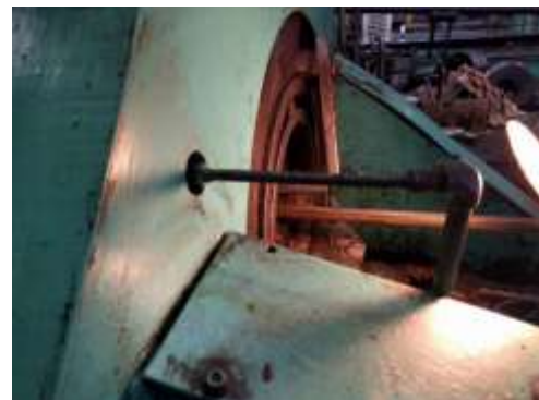
図2 パイプの冷間引抜工程の様子
