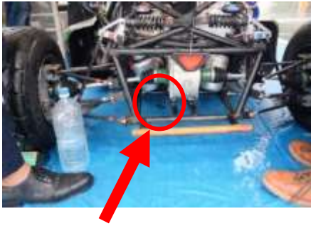
図 4 エンジンオイル漏れの様子
