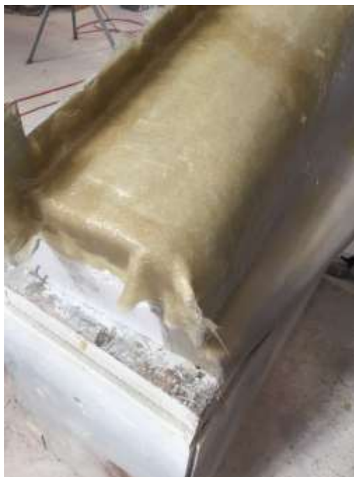
図5 ガラスマットを積層した原型
