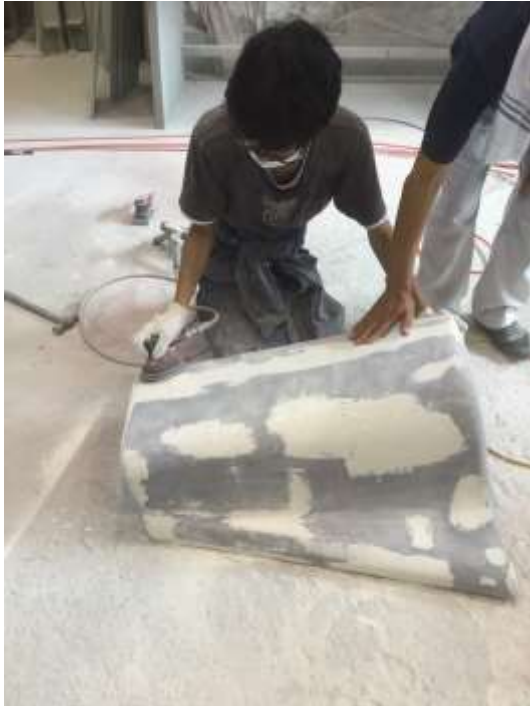
図 7 FRP 製品の表面処理の様子
