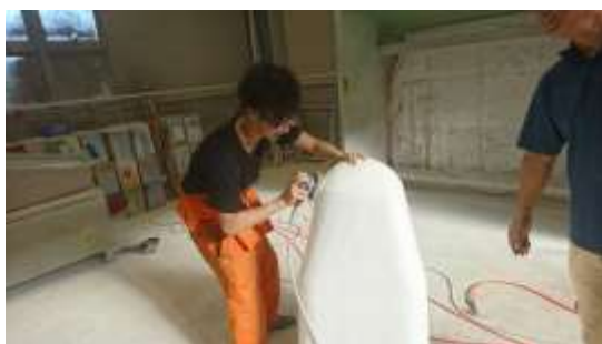
図3 原型表面を磨く様子
