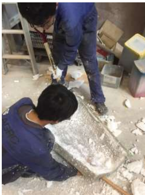
図6 雌型の脱型の様子
