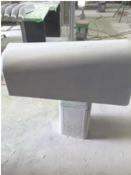
図 8 完成した FRP 製品
