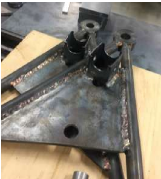
図 9. プッシュロッドステイ溶接
