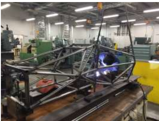
図 2. フレームの溶接風景
