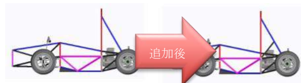
図 6. SHB 追加前後のフレーム構造比較
