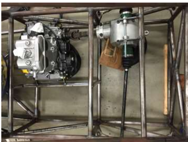
図 2 デフ及びエンジンの取り付けの様子
