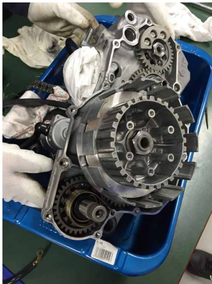
図8 クラッチ部分の分解の様子
